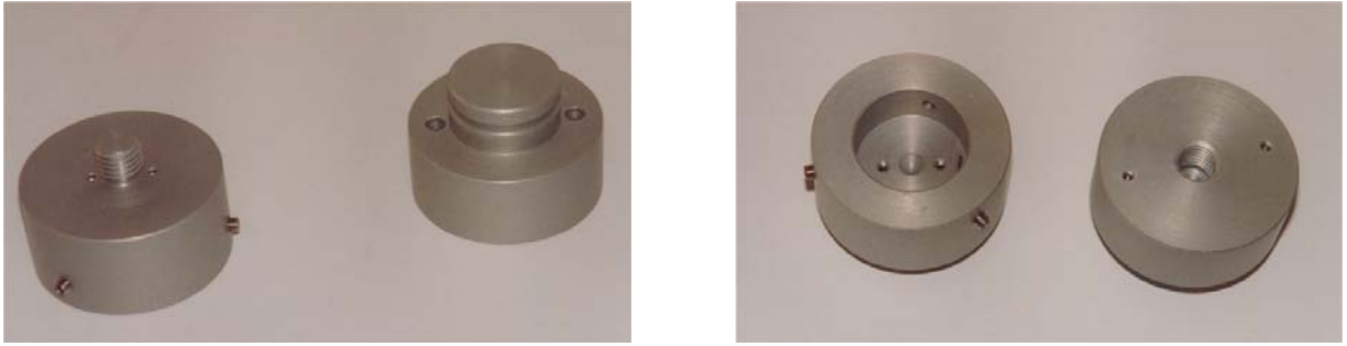
Slika 3.3-4: Razstavljen vmesnik za pritrditev GPS-antene, pogled od zgoraj (levo) in od spodaj (desno).
