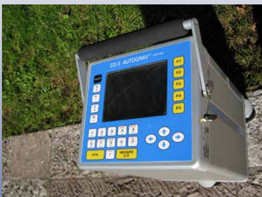
Relativni gravimeter Scintrex CG-5
