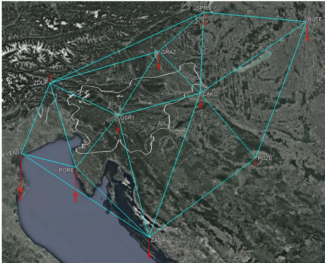
Interpolirani horizontalni vektorji hitrosti na območju Slovenije so prikazani na sliki spodaj. Horizontalni vektor v točki PORE (Poreč) meri 2,5 mm/yr.
