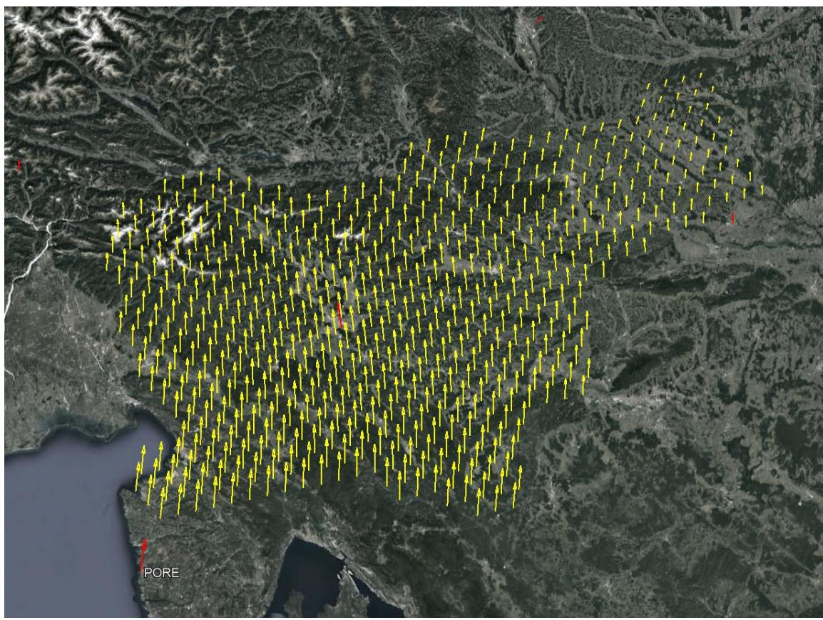
Interpolirani vertikalni vektorji hitrosti na območju Slovenije so prikazani na naslednji sliki. Vertikalni vektor v točki PORE (Poreč) meri 1,6 mm/yr.
