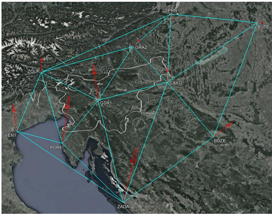
Delaunayjevi trikotniki tvorjeni iz točk modela in vertikalni vektorji hitrosti v točkah modela so prikazani na naslednji sliki. Največji vertikalni vektor v točki VEN1 (Benetke) meri 2,1 mm/yr.
