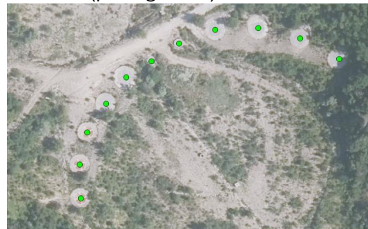
Primer jaškov kot del zaščite pred plazom, Slano Blato, naselje Lokavec (podlaga DOF)
