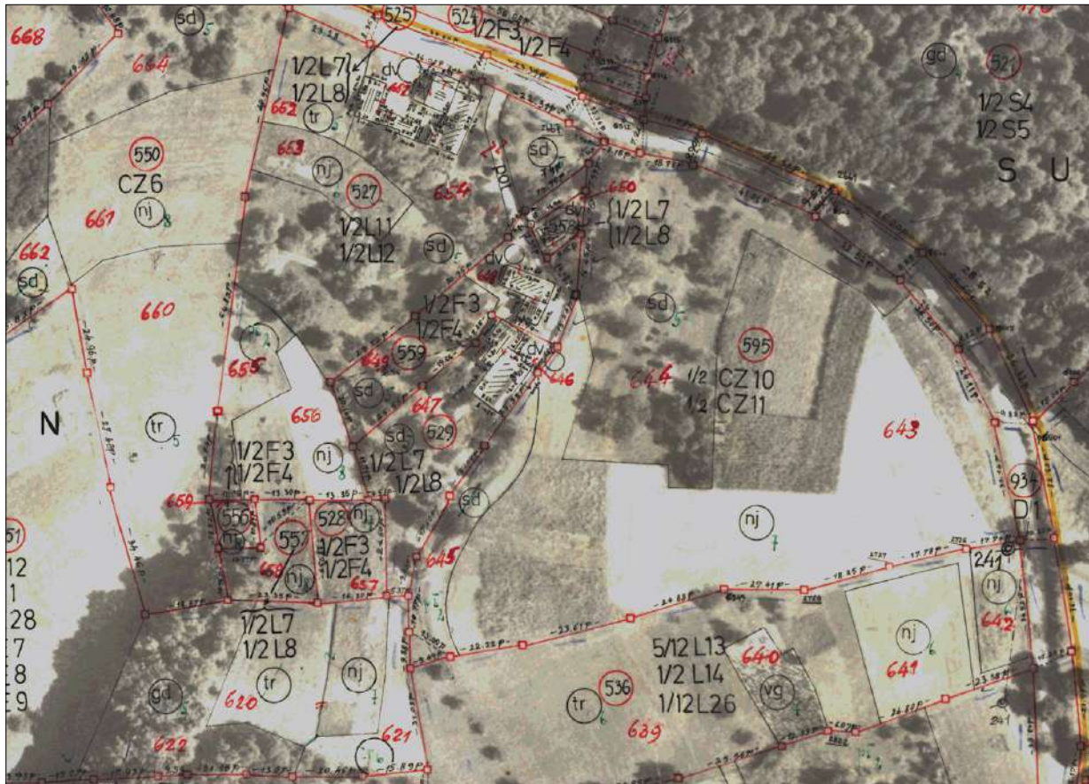
Slika 5.3.1.2: Izrez iz fotoskice stereofotogrametrične nove izmere k. o. 23 Trdkova. V rdeči odebeljeni barvi so vrisane meje posestnih kosov. V črni barvi so s tankimi linijami vrisane parcelne meje znotraj posestnih kosov in tlorisi stavb. Parcelne številke so v rdeči barvi. V črni barvi v rdečih krogcih so vpisane zaporedne številke podpisov lastnikov v zapisnikih MUP. V črni barvi v črnih krogcih so vpisane katastrske kulture s pripisanim katastrskim razredom v zeleni barvi. S šablono so v posostne kose vpisani lastniški deleži in oznake lastnikov.
