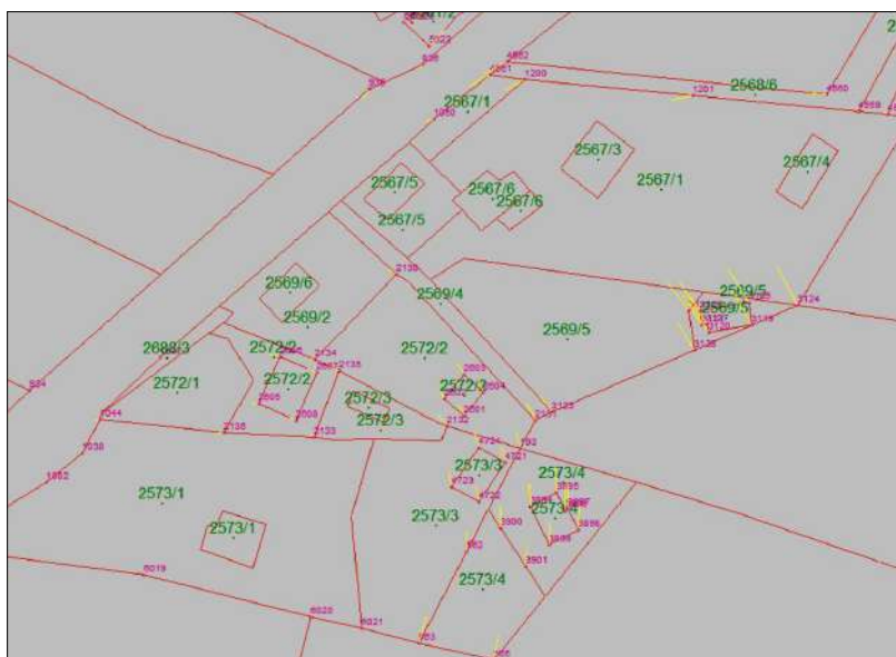
Slika 3.5.1: Prikaz vektorjev (v rumeni barvi) na območju grafičnega katastra v k. o. 1412 Mokronog (zaradi preglednosti prikazano že po zadnjem koraku - uveljavitvi DKN). Vektorji so različnih dolžin in smeri, kar kaže na nehomogene vkelope.
