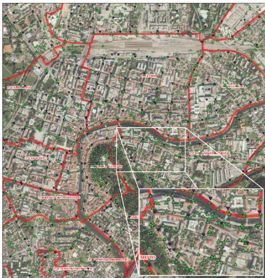
Slika 5.1.1: Prikaz točk geodetske horizontalne (zeleno) in vertikalne (vijolično) mreže na ožjem območju Ljubljane.
