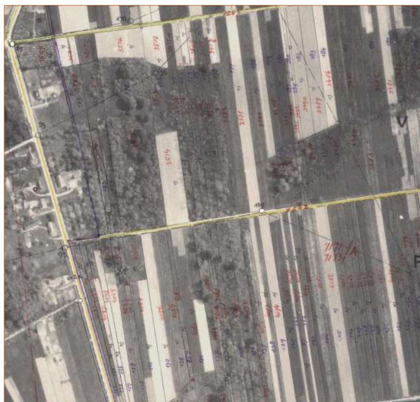
Slika 5.2.4.3: Izrez iz fotokscice enoslikovne fotogrametrične izmere k. o. 129 Gančani. Ob poteh so v sliki vidne bele »pike«, ki predstavljajo mejne točke na parcelnih mejah, na terenu označene z belimi ploskvami na enega od možnih načinov. Glej naslednjo sliko.
