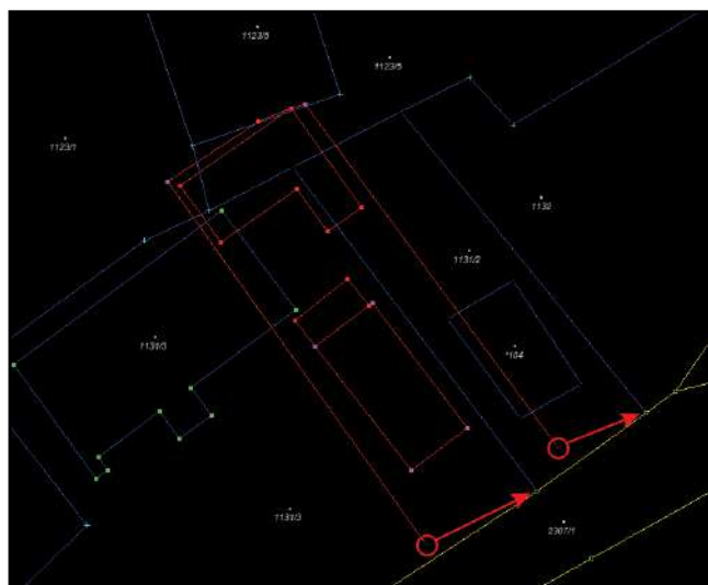
Slika 4.2.1.4: Grafični vklop s pomočjo digitalne tehnologije, dodatno so označene točke za vklop z identičnimi lomi v ZKP.
