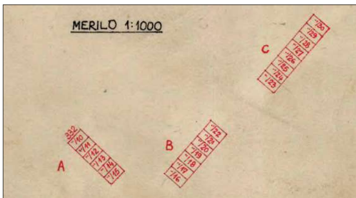
Slika 3.1.2: Izreza iz načrta grafične izmere za k. o. 1527 Semič, na katerem so bili drobni detajli A, B in C vrisani v merilu 1 : 1000 na praznem delu lista v merilu 1 : 2880 in ga je bilo treba vklopiti v osnovni načrt merila 1 : 2880.
