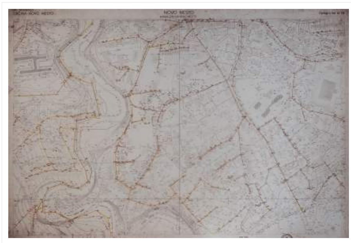
Slika 11.1: Načrt komunalnega katastra, ki ga je geodetska uprava vodila po določilih Zakona o katastru komunalnih naprav.
