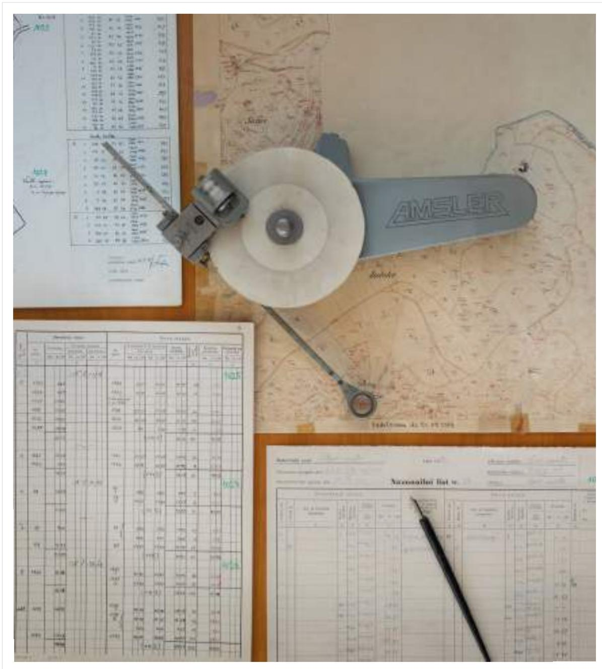
Slika 3.33: Primer izračuna površin s polarnim planimetrom.
