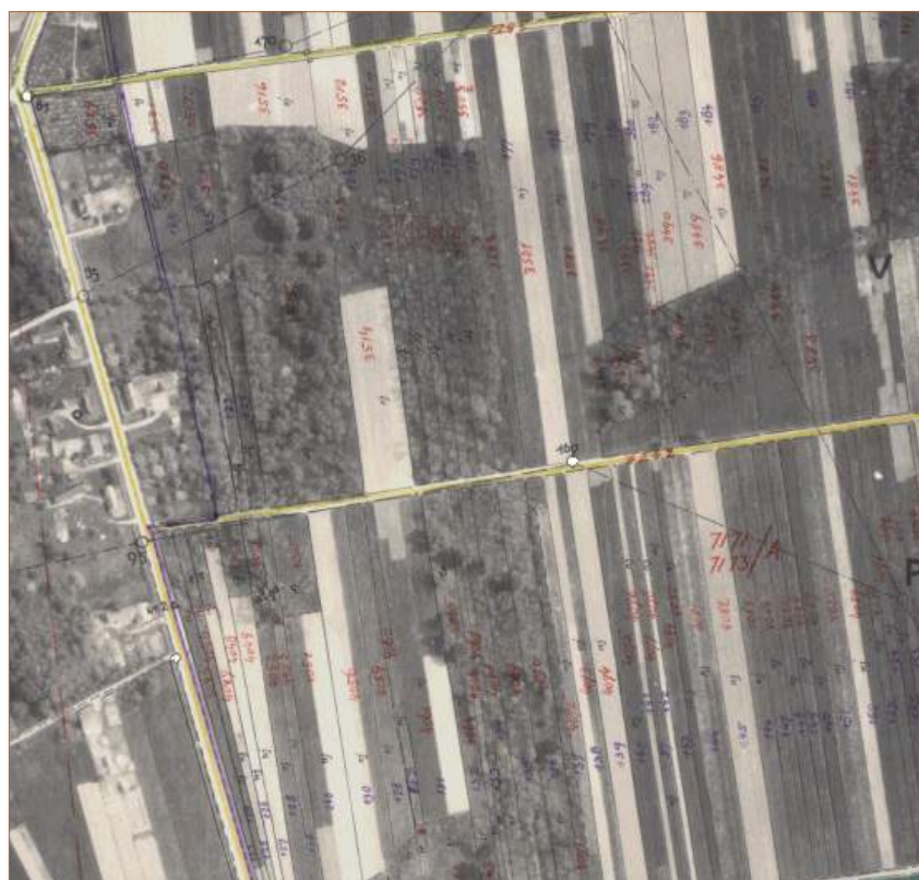
Slika 5.2.4.3: Izrez iz fotoskice enoslikovne fotogrametrične izmere k. o. 129 Gančani. Ob poteh so v sliki vidne bele »pike«, ki predstavljajo mejne točke na parcelnih mejah, na terenu označene z belimi ploskvami na enega od možnih načinov. Glej naslednjo sliko.
