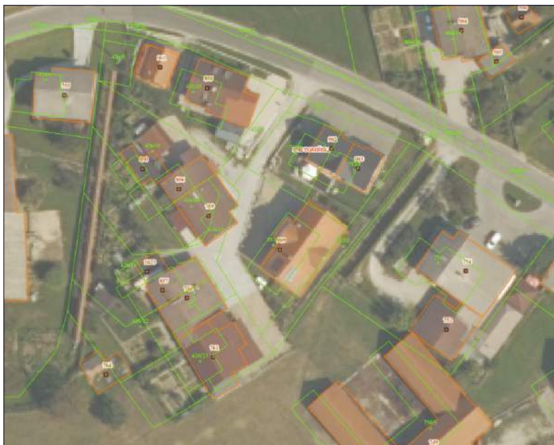
Slika 4.1.1: Prikaz slabe položajne natančnosti ZKP na DOF na območju grafičnega katastra izvirnega merila 1 : 2880 na primeru k. o. 1702 Tomišelj. Vir: PREG, ekranska slika ZKP + DOF
