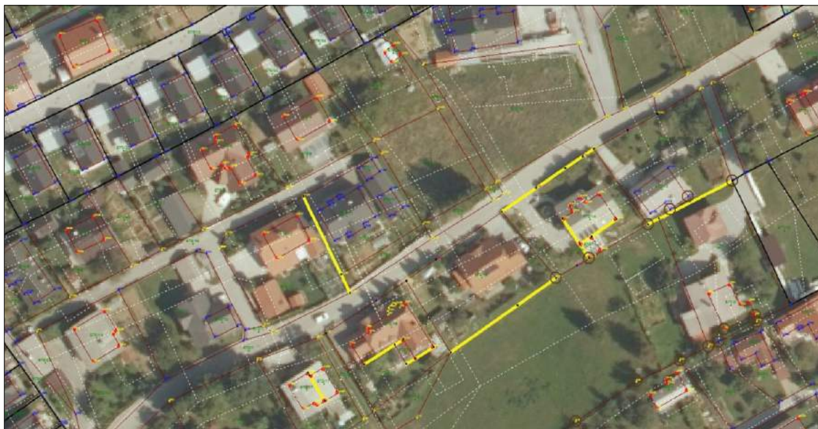
Slika 8.2.8.1: Rezultat izboljšave je izrisan z neprekinjeno črto, za primerjavo je dodano stanje ZKP pred lokacijsko izboljšavo (prikazano z belo črtkano linijo). Vir: PP SysGeoProTM, ekranski prikaz
