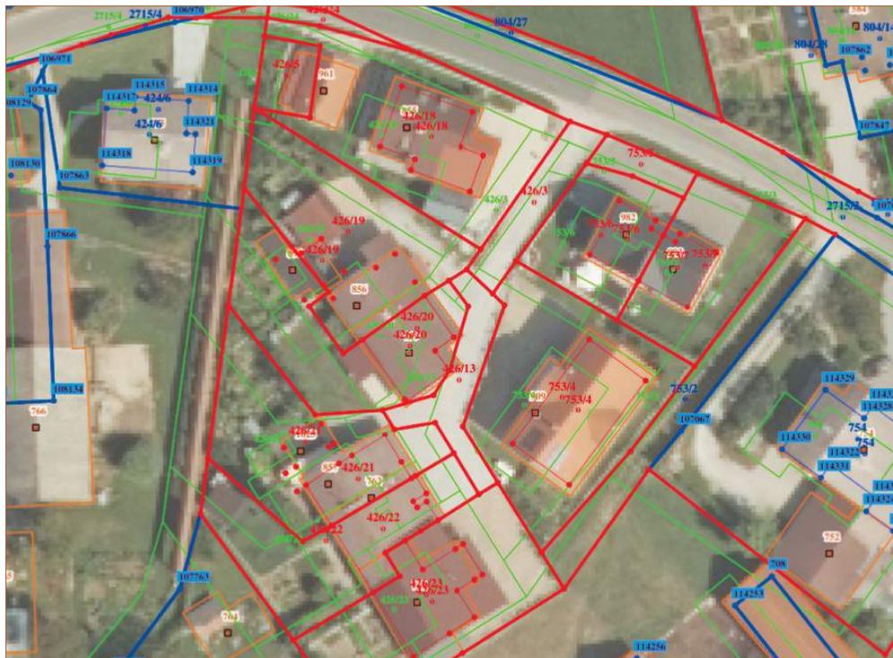
Slika 4.3.6: Prikaz razlike med ZKP in ZKN na območju grafičnega katastra izvirnega merila 1 : 2880 po izvedeni izboljšavi z metodo homogenizacije; v zeleni barvi je prikazan ZKP, ZKN je prikazan v dveh barvah, in sicer so v rdeči barvi prikazane daljice z natančnostjo določitve ZK-točk do 1 m, z modro pa vse ostale, primer k. o. 1702 Tomišelj.
