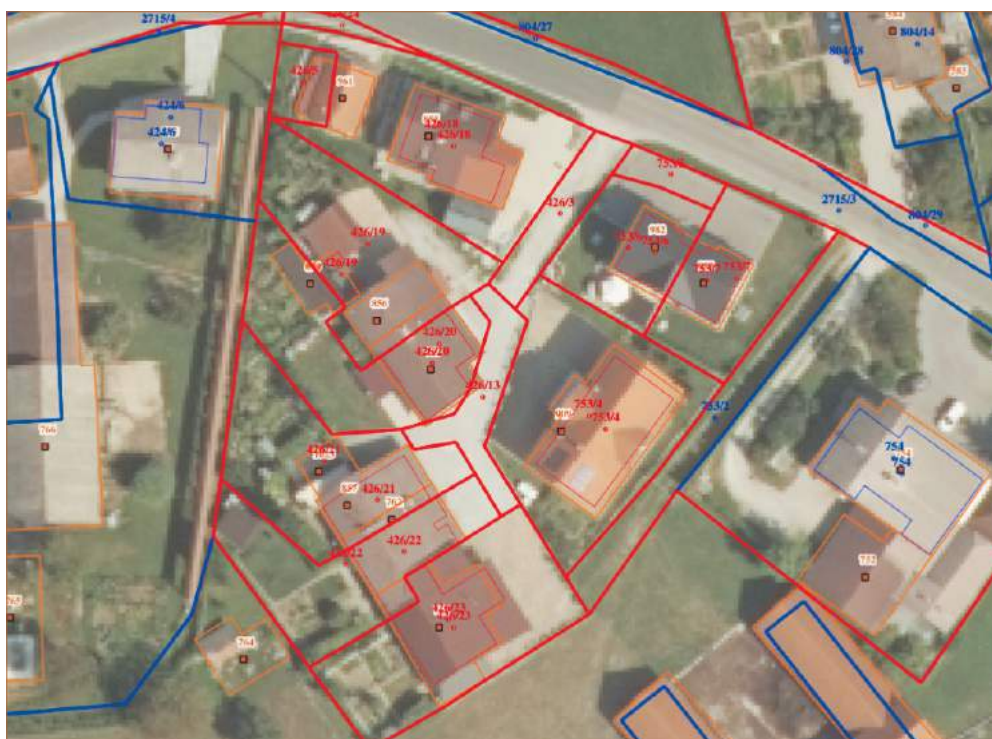
Slika 4.3.5: Prikaz ZKN na DOF na območju grafičnega katastra izvirnega merila 1 : 2880 po izvedeni izboljšavi z metodo homogenizacije; v rdeči barvi so prikazane daljice z natančnostjo določitve ZK točk do 1 m, z modro pa vse ostale daljice (kamor sodijo tudi izboljšane), primer k. o. 1702 Tomišelj. Vir: PREG, ekranska slika ZKN + DOF
