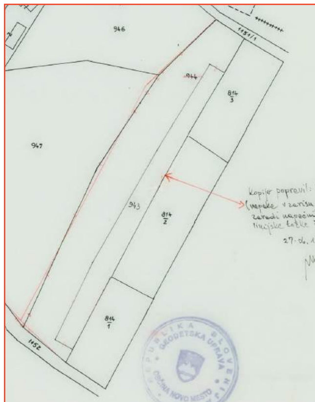
Slika 4.2.1.3: Na primeru v k. o. 1454 Daljni Vrh prikaz uporabe grafičnega vklopa: Izrez iz prosojnice (oelate) kartiranja in izrez katastrskega načrta s spremembami, ki je bil osnova za vzdrževanje analognega načrta.
