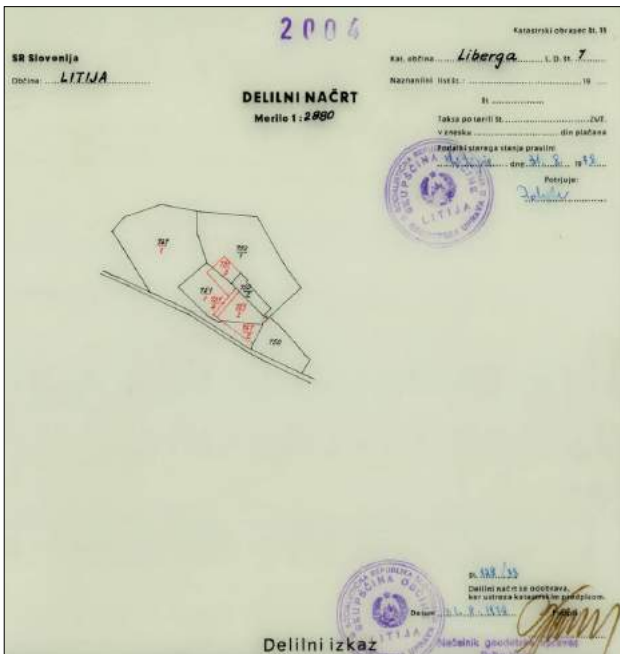
Slika 2.5.21: Del elaborata v k. o. 1846 Liberga, kjer ugotovljene meje v mejnem ugotovitvenem postopku ne izkazujejo popravkov v katastrskem načrtu. Neskladje je lahko tudi odraz slabega vklopa ene od predhodnih parcelacij. Vir: Pregledovalnik digitalnih elaboratov arhiva ZK
