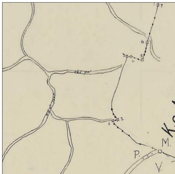
Slika 5.2.1.4: Izrez iz skice zamejničenja mej k. o. s prikazanimi oznakami in številkami stabiliziranih mejnih kamnov.
