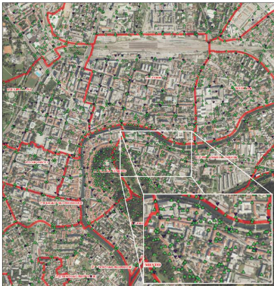
Slika 5.1.1: Prikaz točk geodetske horizontalne (zeleno) in vertikalne (vijolično) mreže na ožiem območju Ljubljane.
