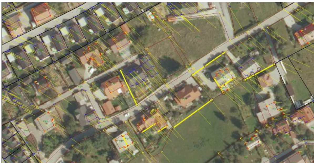
Slika 8.2.8.2: Vektorji na rezultatu izboljšave (kažejo približno v isto smer in so primerljivih dolžin); rumene nevezne točke dobijo koordinate v državnem koordinatnem sistemu E, N glede na vektorje na modrih veznih točkah in ob upoštevanju vnesenih dodatnih geometrijskih pogojev.
