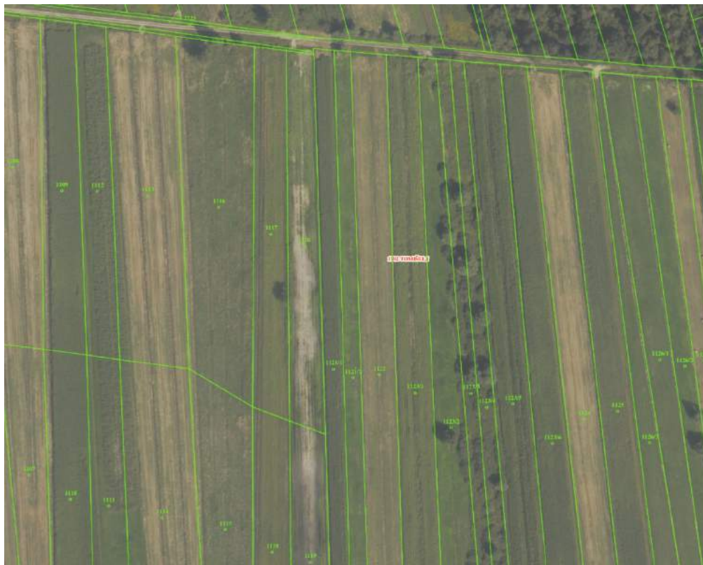
Slika 4.1.2: Prikaz dobre položajne natančnosti ZKP na DOF na območju grafičnega katastra izvirnega merila 1:2880 na primeru k. o. 1702 Tomišelj. Vir: PREG, ekranska slika ZKP + DOF
