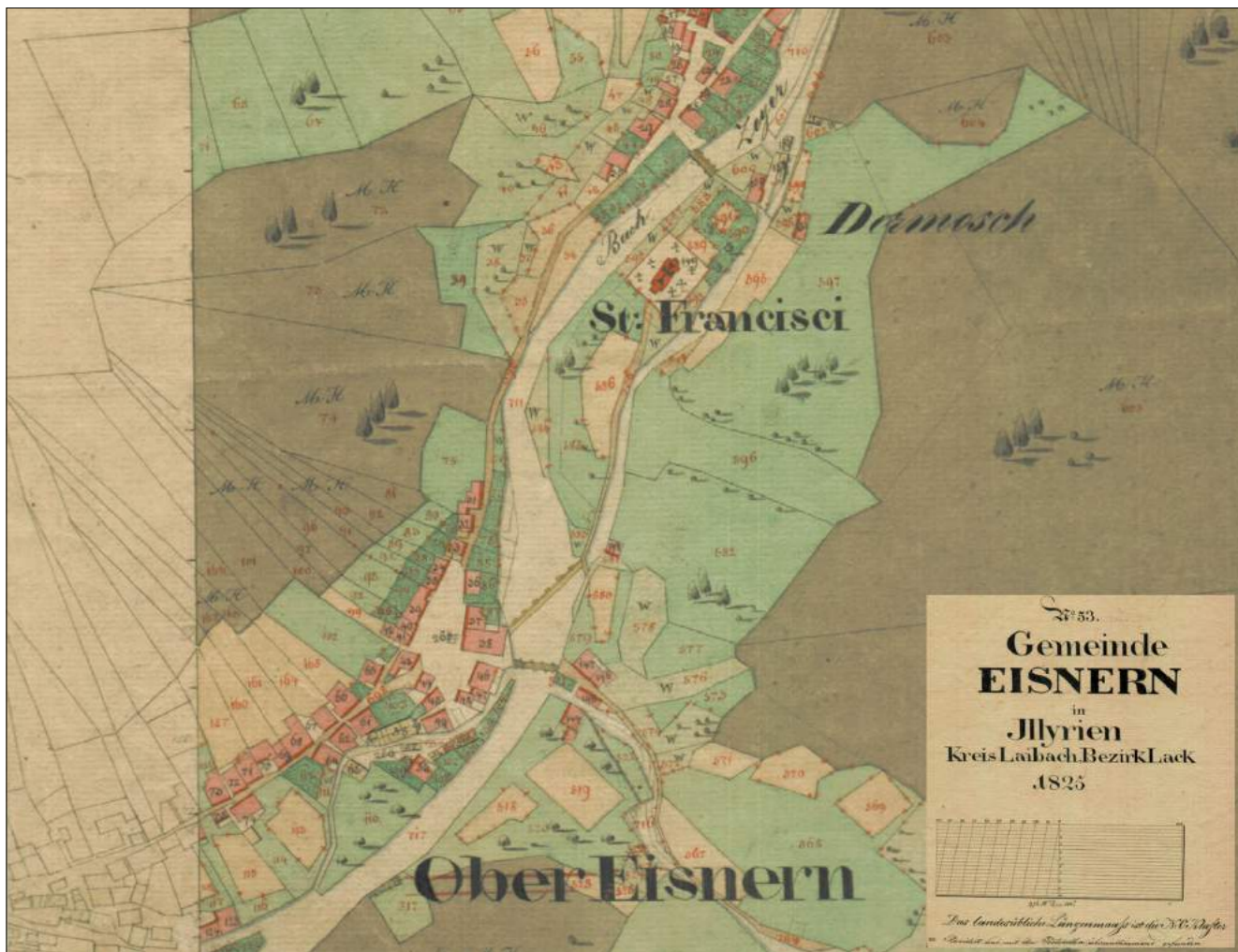
Slika 3.2.5: Izrez iz zemljiškokatastrskega načrta k. o. 2071 Železniki, na katerem je razvidno, da je detalj dorisan preko roba detailnega lista (v takih primerih je bila odločitev o načinu združitve dveh sosednjih listov »lahka«).
